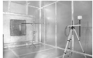
Deux chambres réverbérantes électromagnétiques couplées : Deux cages de Faraday, parfaitement isolées de l'extérieur accolées permettent, grâce à l'émission et la réception de champs diffus, de caractériser les propriétés électromagnétiques d'un matériau placé entre les deux.
